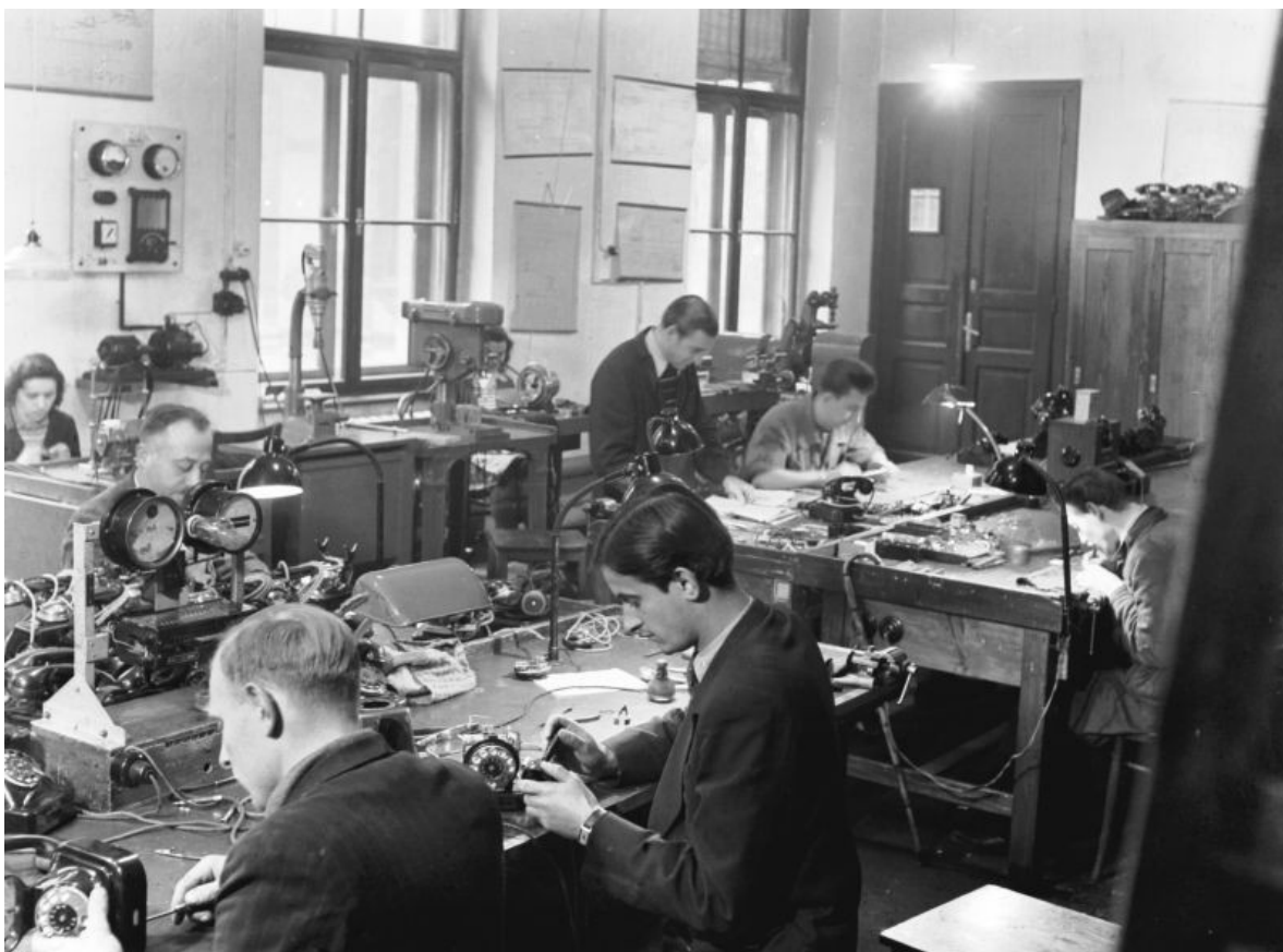
Slika 13. PTT radionica u Zagrebu (oko 1950.) u kojoj su vršeni popravci neispravnih uređaja te izrađivani oni improvizirani za potrebe obnove telefonskoga prometa
